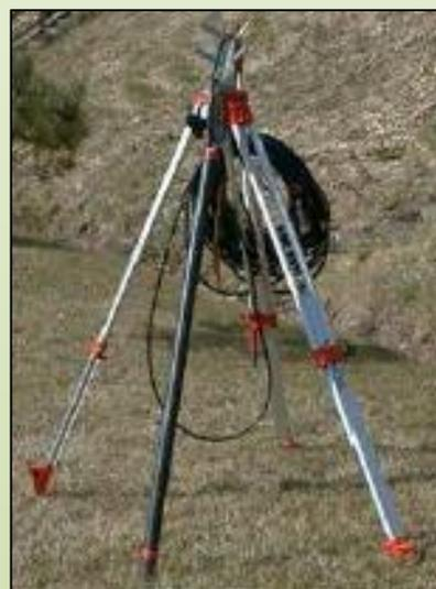
Antenne de forage 150 MHz
